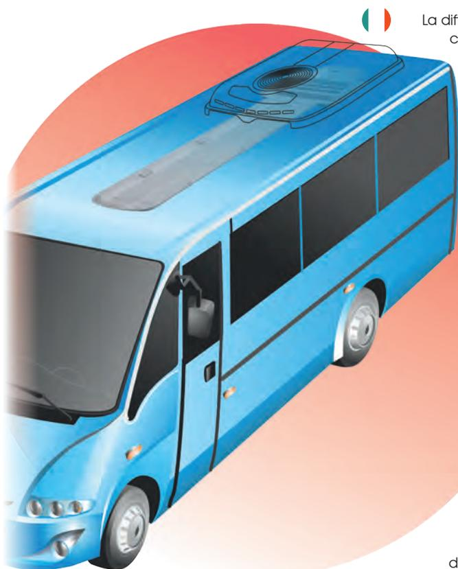
La diffusione dell'aria per il gruppo a tetto RT 110 / RTH 110 è assicurata da un diffusore centrale con 8 bocchette direzionabili o da una serie di canalizzazioni modulari che possono essere composte a scelta per ottenere la lunghezza desiderata; anch'esse dotate di bocchette lungo i canali e sui terminali. Il diffusore centrale o il convogliatore delle canalizzazioni sono dotati di filtro dell'aria.
